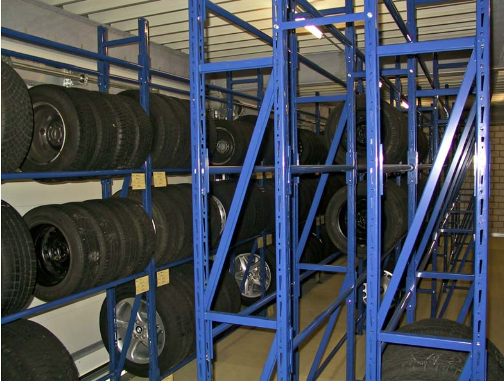
Oben pulverbeschichtete, verschweisste Rahmen, unten verzinkte Rahmen
