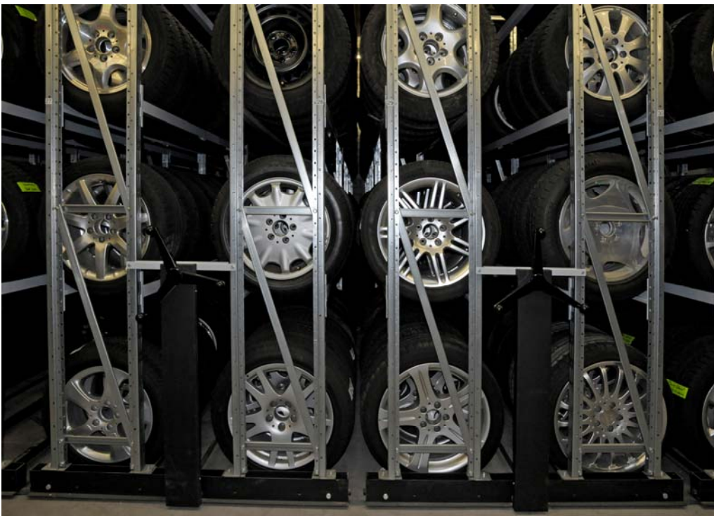
Oben pulverbeschichtete, verschweisste Rahmen, unten verzinkte Rahmen
